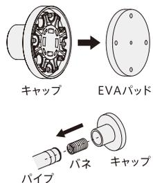
※パネがはずれた場合は、パイプ内部の十字部分にパネを取り付けキャップをはめてください。
